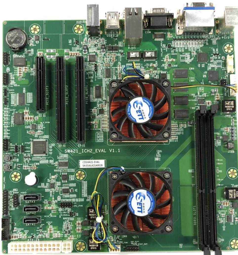
图 2.2: 开发板 TOP 面带散热风扇实物图
